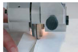
PFAFF 83 10 CS dvojité Nové řešení s dvojitým kolem - verze s plochým lůžkem = současné řezání a svařování
