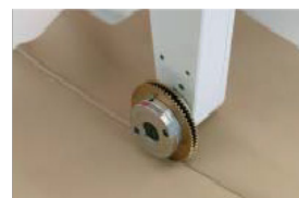
PFAFF 83 10 CS dvojité Nové řešení s dvojitým kolem - verze s plochým lůžkem = současné řezání a svařování
