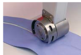
PFAFF 83 12 CS Jednokolejová strojní verze - verze s plochým lůžkem = řezaný okraj a svařování
